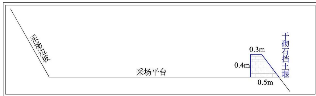
图 5-2 干砌石挡土堰示意图（标注单位：cm）
